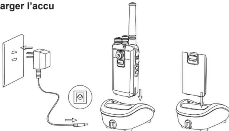
Raccordez le bloc d'alimentation à une prise de courant de 230 V et connectez-le au chargeur, la LED (2) de charge s'allume brièvement en rouge.
