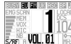
Изначальный дисплей при подключенном дистанционном микрофоне SPK/MIC
